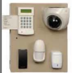
Apparatuur t.b.v toegangscontrole, camera-, inbraak- en brandbeveiliging
